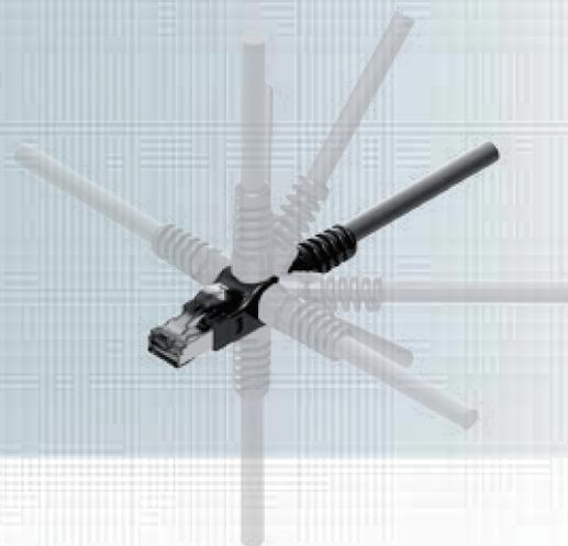
Verbindungskabel RJ45/RJ45 geschirmt, 1:1 Belegung mit winkelverstellbaren Steckern. Dieses Patchkabel ist für den Einsatz in Büros und Rechenzentren geeignet. Das verwendete Kabel bietet mit seinem Kombischirm (PiMf + Geflecht) sowie den 360° geschirmten RJ45-Steckern ein Höchstmaß an Datensicherheit.
